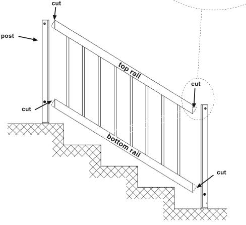
P8\_ RACKING FENCE FOR DROP OVER 500MM\_ 2.0
